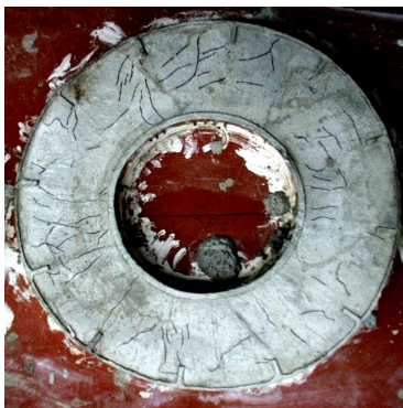
Nullmischung: Starke Schwindrissbildung
